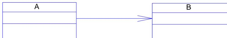
Dans l'exemple ci-dessus, les instances de A voient les instances de B mais les instances de B ne voient pas les instances de A.
