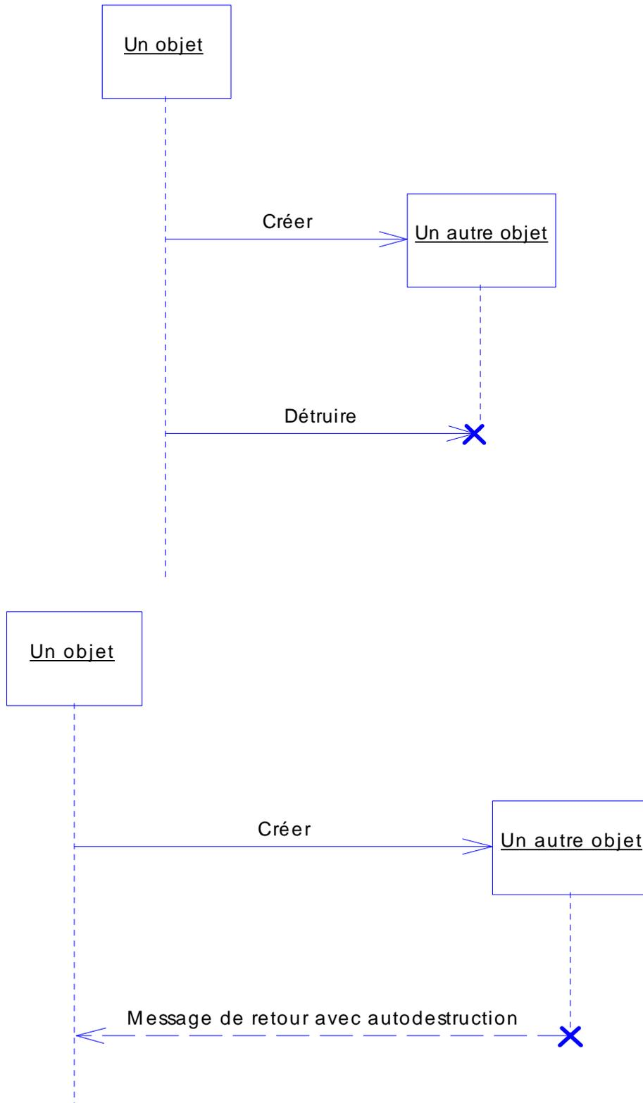
Pour représenter la collaboration entre les objets, on dispose donc dans UML de 2 diagrammes (collaboration et séquence). On peut utiliser l'un ou l'autre, voire les 2. On peut ainsi décrire l'ensemble des interactions avec des messages complets (nom, séquence, résultat attendu, synchronisation et condition d'émission) sur un diagramme de collaboration et compléter cette description par des diagrammes de séquence ne visualisant que les noms des messages.
