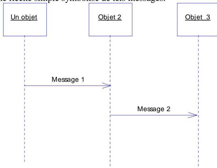
Alternativement, une demi-flèche peut être utilisée pour représenter explicitement des messages asynchrones pour des systèmes concurrents (la flèche pleine correspond alors à un message avec attente de prise en compte).
