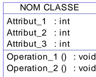
Les compartiments d'une classe peuvent être supprimés (en totalité ou en partie) lorsque leur contenu n'est pas pertinent dans le contexte d'un diagramme. La suppression des compartiments reste purement visuelle : elle ne signifie pas qu'il n'y a pas d'attribut ou d'opération.
