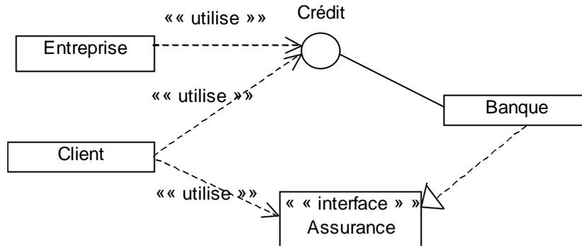
L'exemple ci-dessus illustre la modélisation de 2 interfaces crédit et assurance d'une classe banque. Une relation de réalisation indique que la classe banque réalise l'interface assurance.
