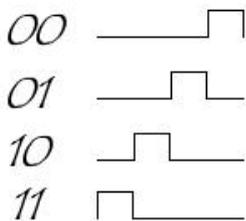
La modulation PPM consiste à transmettre des impulsions à amplitude constante, et à coder l'information suivant la position de l'impulsion. Le débit de 1 Mbps est obtenu avec une modulation de 16-PPM, tandis que le débit de 2 Mbps est obtenu avec une modulation 4-PPM permettant de coder deux bits de données avec 4 positions possibles :
