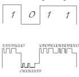
La couche physique de la norme 802.11 définit une séquence de 11 bits (10110111000) pour représenter un 1 et son complément (01001000111) pour coder un 0. On appelle *chip* ou *chipping code* (en français puce) chaque bit encodé à l'aide de la séquence. Cette technique (appelée *chipping*) revient donc à moduler chaque bit avec la séquence *barker*.
