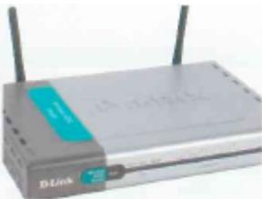
Notés AP pour *Access point*, parfois appelés bornes sans fil, permettant de donner un accès au réseau filaire (auquel il est raccordé) aux différentes stations avoisinantes équipées de cartes WiFi. Cette sorte de hub est l'élément nécessaire pour déployer un réseau centralisé en mode infrastructure. Certains modèles proposent des fonctions de modem ADSL et comprennent plus ou moins de fonctions comme un pare-feu.
