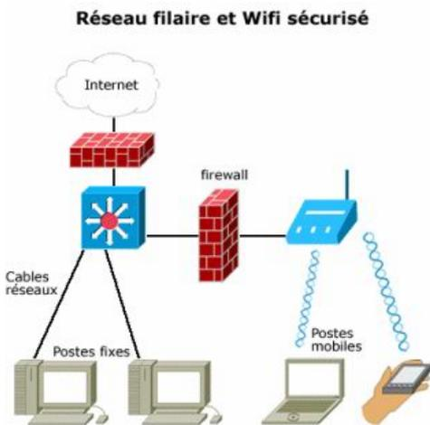
On peut aussi installer un **firewall** comme si le point d'accès était une connexion internet. Ce firewall peut être le serveur **IPsec (VPN)** des clients sans fils.
