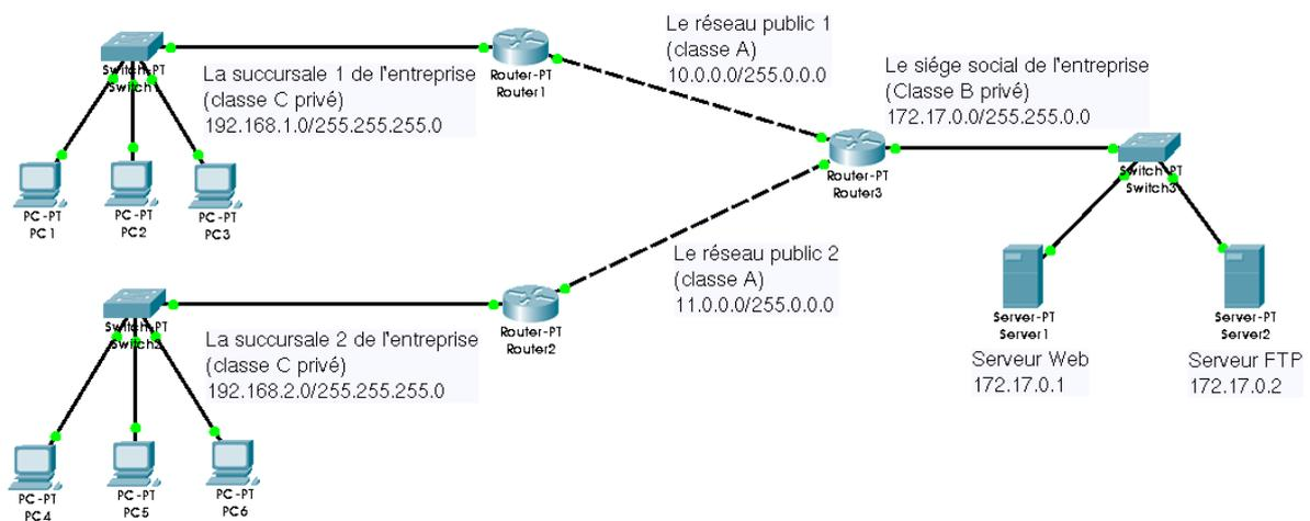
Les réseaux publics pourront utiliser par exemple une liaison de type ADSL. Il faudrait rajouter au schéma ci-dessus des modems ADSL (ou modem/routeurs ADSL). Dans notre étude de cas, nous utiliserons une liaison de type Ethernet.
