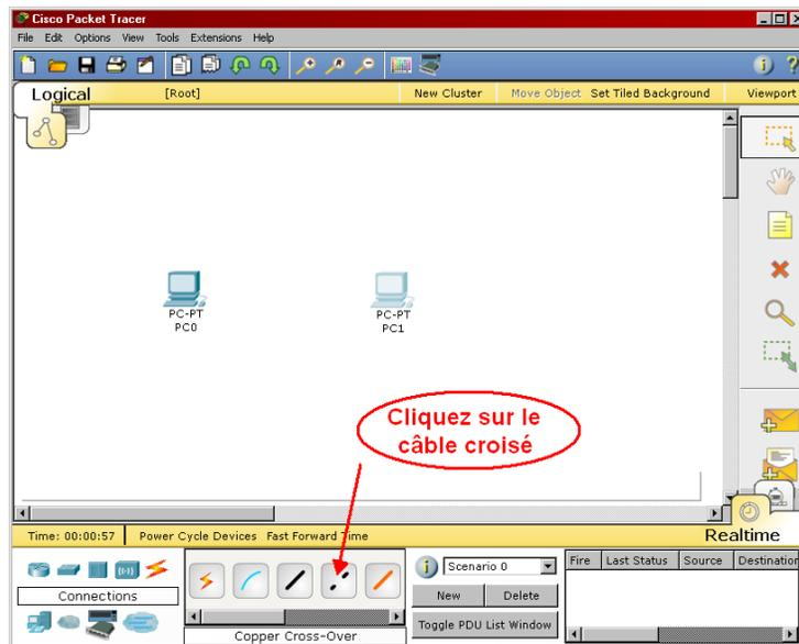
Pour établir une connexion entre nos deux ordinateurs, cliquez d'abord sur notre ordinateur de gauche dans la zone de travail et indiquez qu'il s'agit d'une connexion réseau («Fast Ethernet») :
