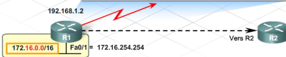
Spécifiez RIP version 2 et indiquez au routeur le nom des réseaux à annoncer. Utilisez la commande network pour chaque réseau directement connecté. R1 connecte trois réseaux, qui doivent être spécifiés ici.
