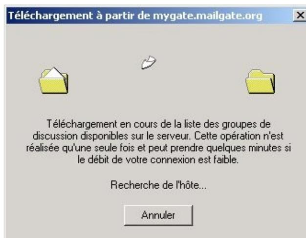
Dans une première phase, il recherche le serveur, puis se connecte, puis télécharge. Dans le cas où la connexion est impossible, une fenêtre d'avertissement s'affiche. Il présente un bouton *Détails* >> pour connaître la raison de l'échec.
