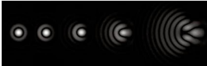
FIGURE 5.6 – Image d'une source lumineuse ponctuelle au milieu du champ visuel (à gauche). Plus on s'éloigne de l'axe optique, plus l'aberration de coma devient importante.
