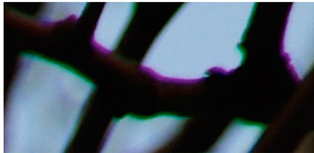
FIGURE 5.14 – Exemple du phénomène de l'*aberration chromatique latérale*. Si on photographie des éléments qui ne sont pas proches de l'axe, on voit apparaître une irisation autour de la tache image du sujet photographié, car les foyers pour les différentes couleurs sont étalés dans le plan du film.
