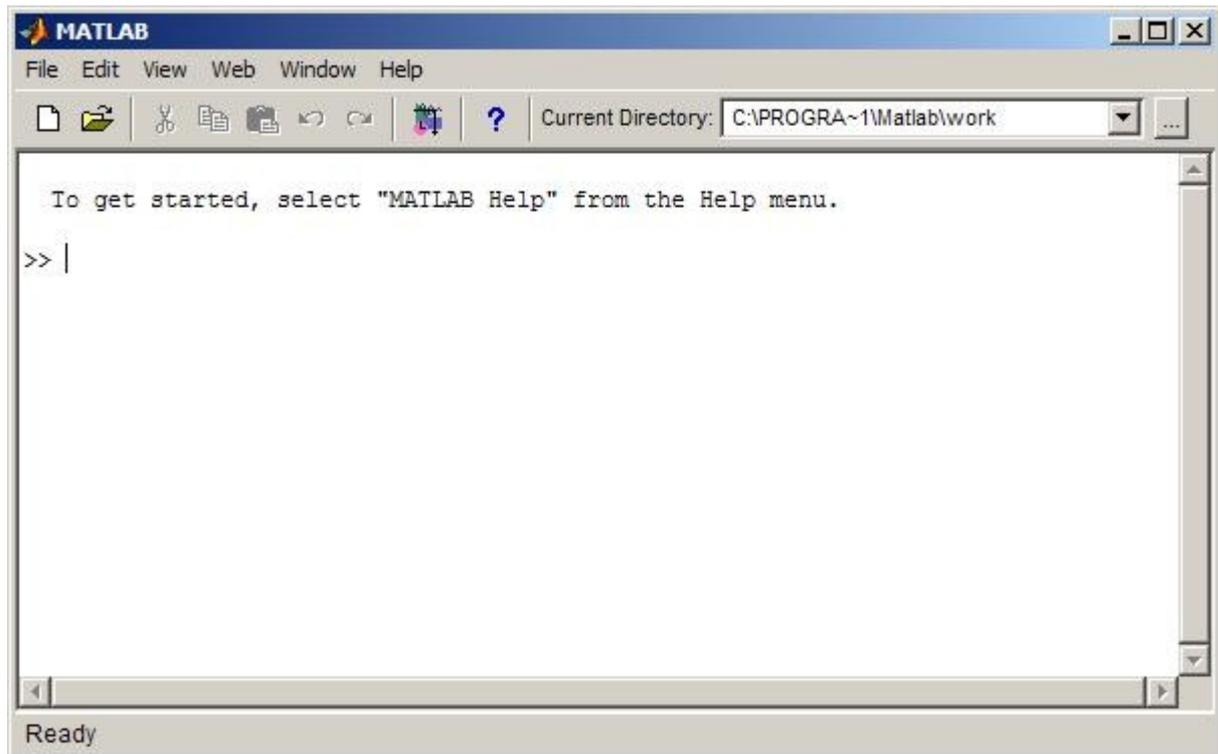
Les menus et les boutons au sommet de la fenêtre permettent d'accéder à certaines fonctionnalités de Matlab sous Windows (éditeur de scripts, gestion des variables, gestion des chemins d'accès,...). Au centre de la fenêtre, on trouve la ligne de commande de Matlab qui permet d'entrer des instructions et de lire les résultats. C'est là que nous allons travailler.
