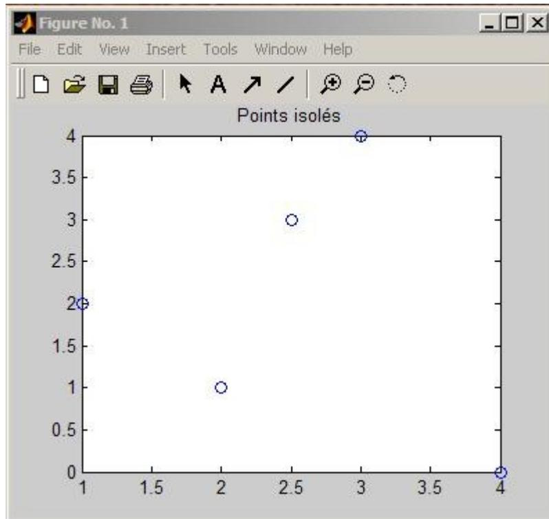
Comme vous avez pu le constater, la commande `figure` fait apparaître une nouvelle fenêtre dans laquelle le prochain graphe sera dessiné. L'appel à la fonction `plot`, non précédé de cette commande, efface le graphe actuel pour dessiner le nouveau. Pour faire apparaître 2 courbes sur le même graphe, il faut remplacer, dans la série de commandes ci-dessus, la commande `figure` par la commande `hold on`.
