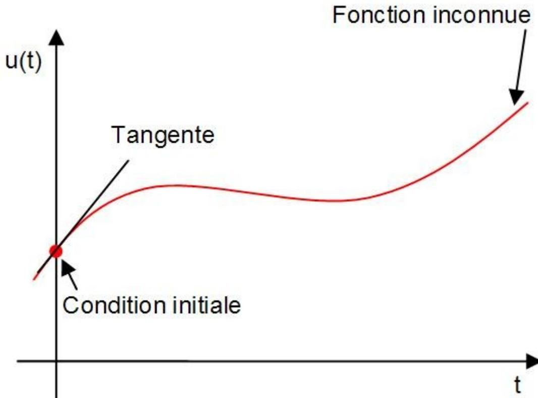
La suite de l'histoire est assez simple. ODE45 va calculer la valeur de la fonction inconnue en  $t=T_1$  en utilisant 2 approximations différentes de cette fonction inconnue (même principe que celui de la tangente ci-dessus). Si les 2 estimations sont proches, il garde la plus précise. Si ce n'est pas le cas, il choisit un  $T_1$  plus proche de  $T_0$  (on se rappellera que plus on se rapproche de  $T_0$ , plus la fonction colle à sa tangente).
