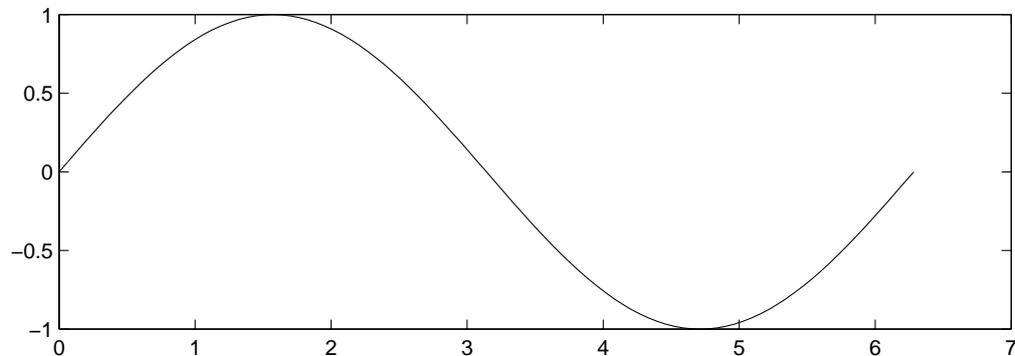
On voit que les axes s'adaptent automatiquement aux valeurs extrémales des abscisses et ordonnées.
