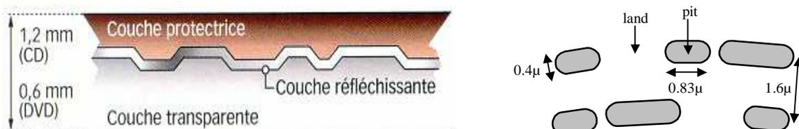
Fig. III.25 : coupe et vue de face d'un CD-ROM
