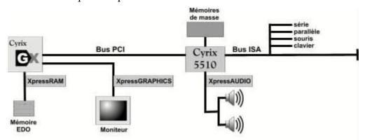
Le processeur est "assisté" par un chip compagnon nommé Cx5510, qui s'occupe des interfaces pour les mémoires de masse. Une telle machine ne dispose plus de mémoire graphique ou de cache L 2, tout est unifié. Compaq est le principal grand constructeur a avoir commercialisé des machines à base de MediaGX.
