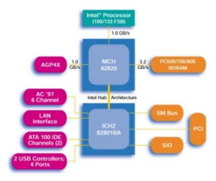
Le chipset i820 d'Intel, lancé le 15 novembre 99, à été conçu spécifiquement pour supporter les nouveaux processeurs Pentium III. C'est le premier chipset Intel à supporter la fréquence de bus 133  $MHz^{51}$ .
