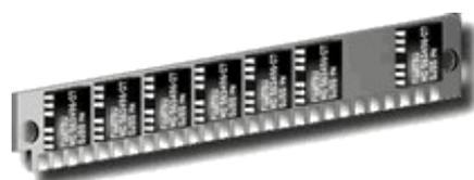
La mémoire **SIMM** (Single In-Line Memory Module) de 8 bits se présente sous la forme d'une barrette d'environ 8.5 cm de long, sur laquelle sont fixés des composants électroniques. Elle est aussi souvent appelée barrette SIMM 30 pins. On les place dans des connecteurs groupés par deux (386SX) ou quatre (dès le 386DX), généralement les cartes mères comportent deux bank
