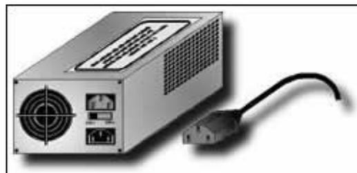
Les alimentations des ordinateurs ne sont ni plus ni moins que des transformateurs qui abaissent dans un premier temps la tension du secteur de 220 volts en tension acceptable par les circuits. La tension de fonctionnement doit pouvoir varier entre **220 volts** et **230 volts**.
