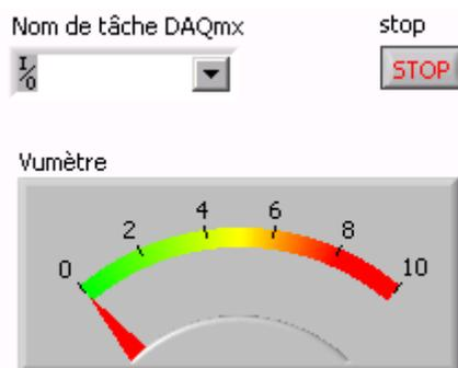
Le capteur fournit une tension comprise entre 0 et 0.4V. Calibrez l'échelle du vu-mètre en conséquence. (le gain donné à la voie de mesure n'affecte pas la valeur lue en sortie)
