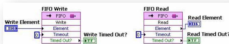
Figure 17-41 Nœuds d'accès "Read/Write" des FIFO
