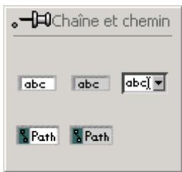
Utiliser la palette **Chaîne&chemins pour** créer des commandes et des indicateurs de type chaîne. La taille du cadre d'affichage est modifiable à l'aide de l'outil flèche. Il est possible d'afficher une barre de défilement pour les textes longs en sélectionnant **Eléments visibles»Barre de défilement**.
