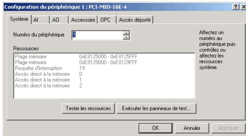
Cette fenêtre possède plusieurs onglets. Le premier onglet, **Système**, indique les ressources système assignées à la carte et le **numéro du périphérique** qui vous servira dans LabVIEW. Les autres onglets permettent de configurer les paramètres d'entrées/sorties analogiques. Appuyez sur le bouton **Tester les ressources** pour vérifier la configuration de la carte.
