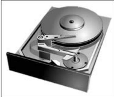
Les dimensions du disque dur sont aussi réduites que possible, car les disques remplissent pratiquement tout l'espace disponible. Le disque dur se compose seulement de quelques parties mobiles, qui doivent naturellement être aussi résistantes à l'usure et aussi fiables que possible.
