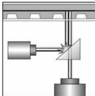
Par contre, si un trou est rencontré, il va dévier le rayon laser qui ne pourra être réfléchi correctement. Le capteur photosensible ne recevra alors aucun signal.
