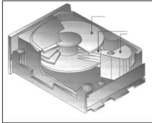
On ignore souvent que la plupart des disques durs se composent, sur le plan interne, de plusieurs disques. Ces disques sont en général appelés des plateaux. Le nombre de plateaux que comporte un disque dur dépend de sa capacité et de sa conception. Les faces de chaque disque, comme celles d'une disquette, sont recouvertes d'une couche magnétique.
