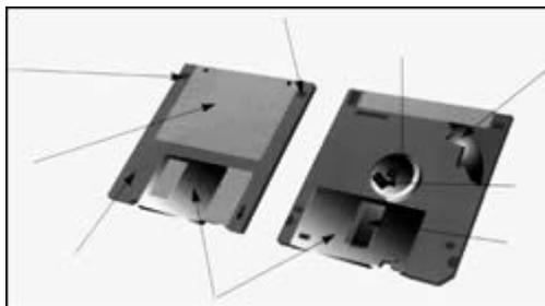
Une disquette n'est autre qu'un disque en **mylar** (plastique ayant une très bonne stabilité dimensionnelle) recouvert d'oxyde magnétique sur toute sa surface.
