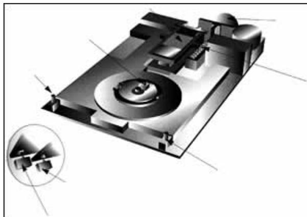
Un lecteur se compose tout d'abord d'un moteur d'entraînement de la disquette. Il peut être relégué dans un coin du châssis et entraîner la disquette. Il est placé sous le centre de la disquette et entraîne alors celle-ci directement.
