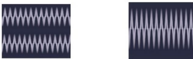
Il se trouve qu'au moment où les signaux de faibles fréquences s'annulent, les signaux de hautes fréquences s'additionnent.
