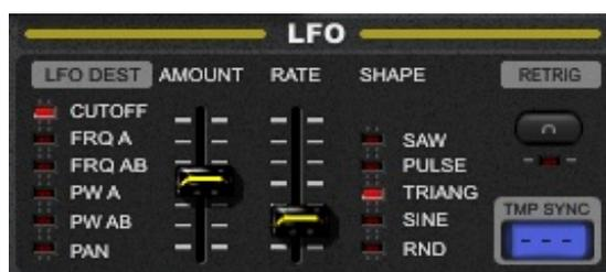
Voici un exemple, c'est le LFO de Piozone. Tout à gauche on peut choisir à quel paramètre on assigne le LFO, *AMOUNT* permet de régler l'impacte, *RATE* la vitesse et *SHAPE* la forme.
