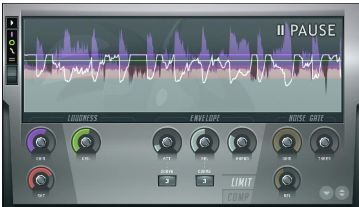
Il s'agit d'un double compresseur qui possède un limiteur, un compresseur simple et un *noise gate*. Il a la particularité d'avoir une vue sur le son unique !
