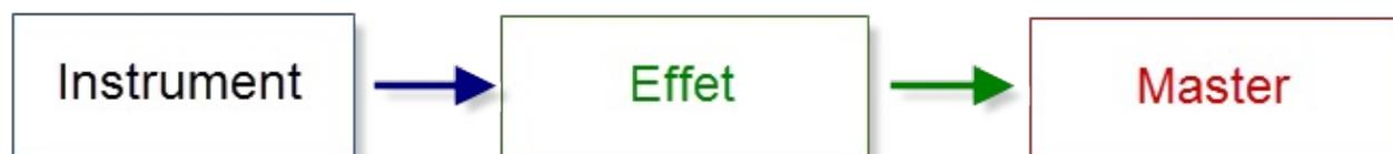
Voici l'exemple d'un effet placé dans une voie normale, l'intégralité du son émis par l'instrument passe dans l'effet. Il en est autrement quand on place un effet dans une voie « send » :
