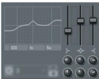
Il permet d'atténuer ou d'amplifier certaines fréquences. La glissière verticale permet de régler le niveau, le premier bouton rotatif la fréquence et le deuxième la pente.
