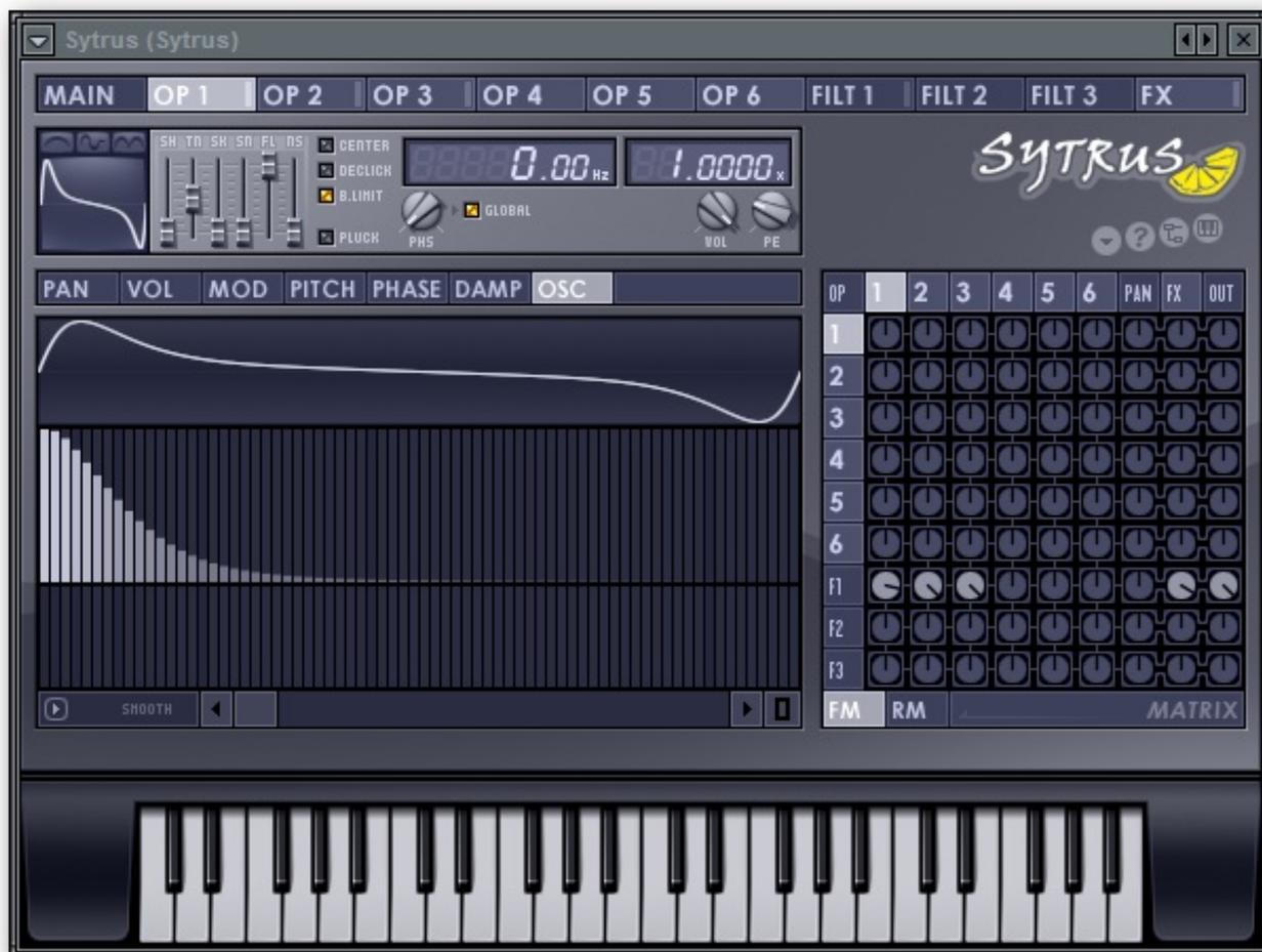
Il combine modulation de fréquences FM, modulation en anneau RM, modulation des cordes pincées, synthèse soustractive, et enfin, il dispose d'un puissant éditeur d'enveloppe.
