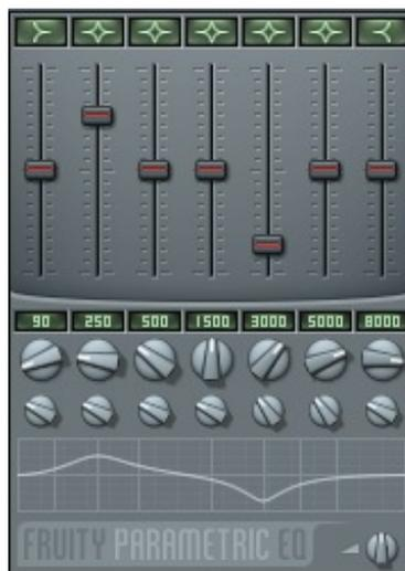
C'est un égaliseur **paramétrique** 7 bandes avec un usage léger des ressources. Paramétrique veut dire que l'on choisit pour chaque bande à quel fréquence elle est appliquée (gros bouton rotatif). Le petit bouton rotatif sert à régler la pente et la glissière verticale règle le niveau. Les rectangles vert du haut permettent de choisir le type de filtre de chaque bande (un égaliseur c'est plusieurs filtres).
