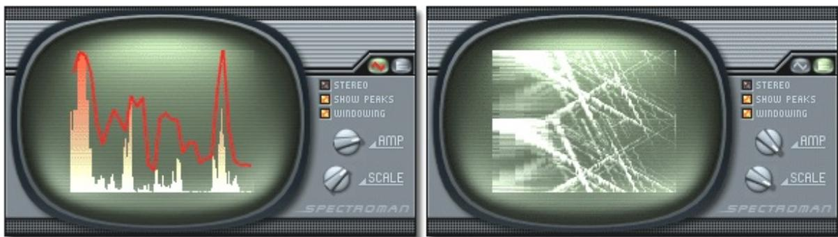
C'est un analyseur de spectre simple. Les basses sont à gauche et les aigus à droite.
