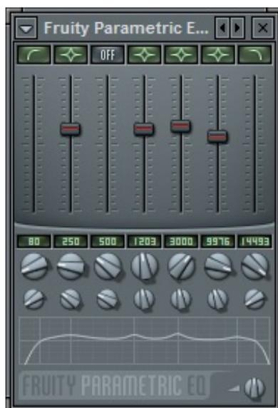
Dans cet exemple j'ai appliqué un passe-haut à 80Hz, c'est tout ce qu'il y a de plus normal. En général on applique un passe-haut à 80 ou 90 Hz.
