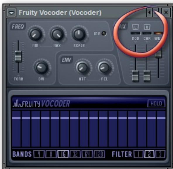
Observez ce qui est entouré, on va devoir envoyer « Modulator » à gauche et « Carrier » à droite. Il faut donc tourner le bouton « Pan » de « Modulator » complètement à gauche puis l'envoyer à la piste où se trouve le *vocoder* (en n'oubliant pas de supprimer l'envoi sur la piste Master) :
