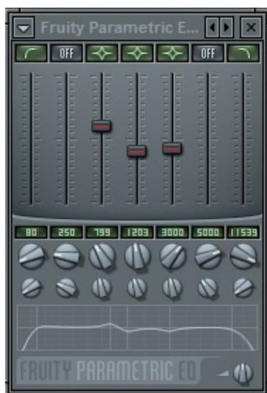
Ici le passe-haut est à 80Hz aussi. Le passe bas est 12KHz environ (11539Hz).
