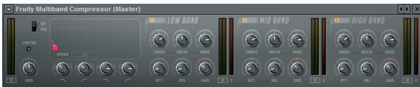
À droite, on retrouve les trois compresseurs avec les réglages principaux. Pour chacun des compresseurs, on dispose d'une visualisation du signal entrant et sortant (il faut cliquer sur le cadre *in* en dessous) et de compression en rouge.
