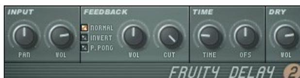
Il s'agit d'une version amélioré du *delay* avec des contrôles plus fins et quelques fonctions supplémentaires comme le réglage de l'entrée et l'offset sur le retard.
