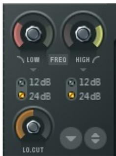
Pour la pente, on a le choix entre 12 et 24 Db par octave. Pour finir, il y a un filtre passe haut (*lo.cut*). De la pratique est nécessaire pour bien comprendre.
