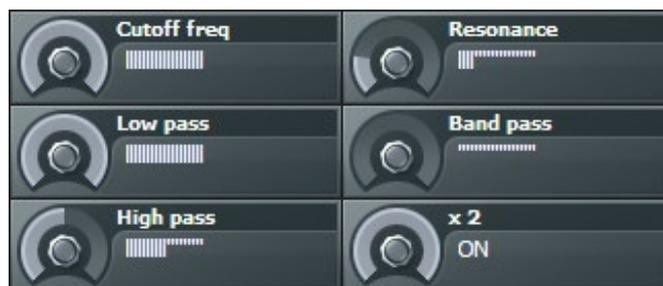
C'est en quelques sorte le regroupement de trois types de filtres différent avec une fréquence de coupure et une résonance commune.
