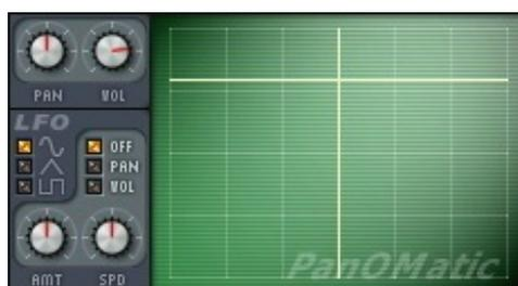
Légèrement plus sophistiqué, cet effet vous permet de contrôler le volume et la balance avec un graphique interactif. PanOMatic est surtout utilisé pour son LFO réglable que l'on peut appliquer sur le volume ou la balance. Vous pouvez régler la forme de la variation du LFO, son impacte (*AMT*), sa vitesse (*SPD*) et sa destination (*OFF*, *PAN* ou *VOL*).
