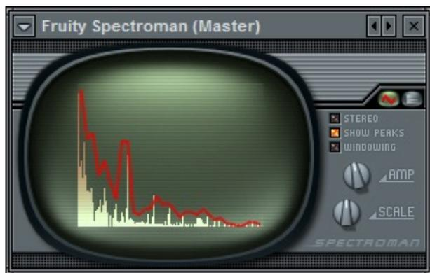
Ici, je vois qu'il faut atténuer les pics et augmenter les creux, mais sur un autre instrument. Par exemple, un creux sur cet instrument veut dire qu'il y a de la place pour qu'un autre instrument vienne combler ce creux. En contrepartie, il faudra que j'atténue les fréquences correspondant au pic pour ne pas empiéter sur cet instrument. Je rappelle que si vous placez votre curseur dans la partie visuelle, la fréquence correspondante sera affichée dans la barre d'information.
