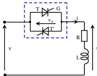
On donne  $R = 100\Omega$ ,  $L = 50\text{mH}$ ,  $u$ : tension aux bornes de la charge et  $i$ : courant de charge.
