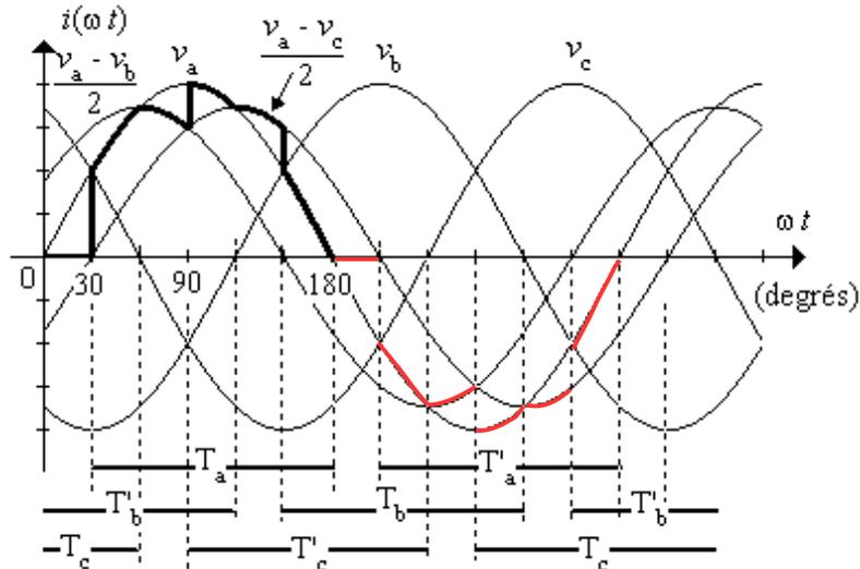
**II. Démarrage d'un moteur asynchrone (fonctionnement sur charge inductive pure)**
