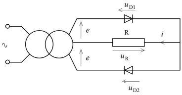
**N.B.** dans ce montage, chaque diode supporte *en inverse* une tension égale à  $2 \times E\sqrt{2}$
