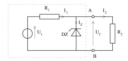
La diode Zéner a pour caractéristiques  $U_{Zo} = 6V$  et  $R_Z = 5 \Omega$ . -  $R_1 = 30 \Omega$
