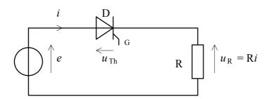
**N.B.** Un générateur d'impulsions synchronisé par la tension d'alimentation permet de rendre passant le thyristor avec un retard  $t_0$  identique à chaque période.
