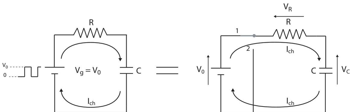
FIG. 2.6 – À gauche : circuit de charge d'un condensateur dans le cas d'une alimentation en créneaux. La tension est dans son alternance haute (tension constante  $V_0$ ) et le condensateur se charge. À droite : circuit de charge d'un condensateur dans le cas d'une alimentation par une tension continue  $V_0$ . **Ces deux schémas sont équivalents !**
