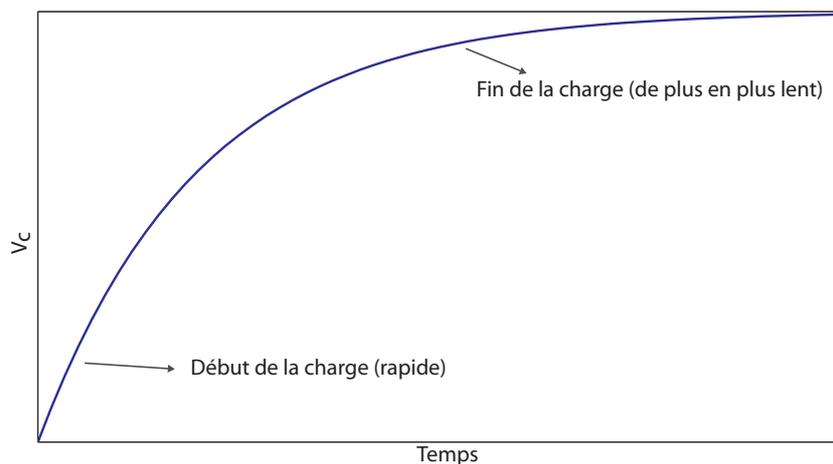
FIG. 2.2 – Esquisse du graphe de la charge d'un condensateur.
