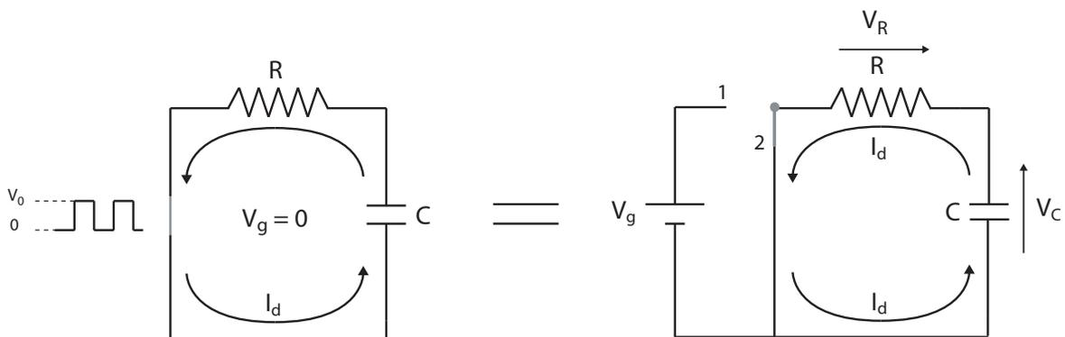
FIG. 2.7 – À gauche : circuit de décharge d'un condensateur dans le cas d'une alimentation en créneaux. La tension est dans son alternance basse (**tension nulle, ce qui revient à fermer le circuit par un fil**) et le condensateur se décharge. À droite : circuit de décharge d'un condensateur dans le cas d'une alimentation par une tension continue  $V_0$ . **Ces deux schémas sont équivalents !**
