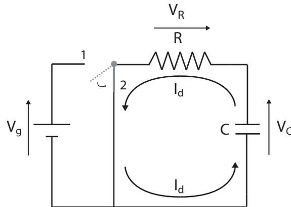
FIG. 2.4 – Décharge du condensateur à travers la résistance  $R$ .
