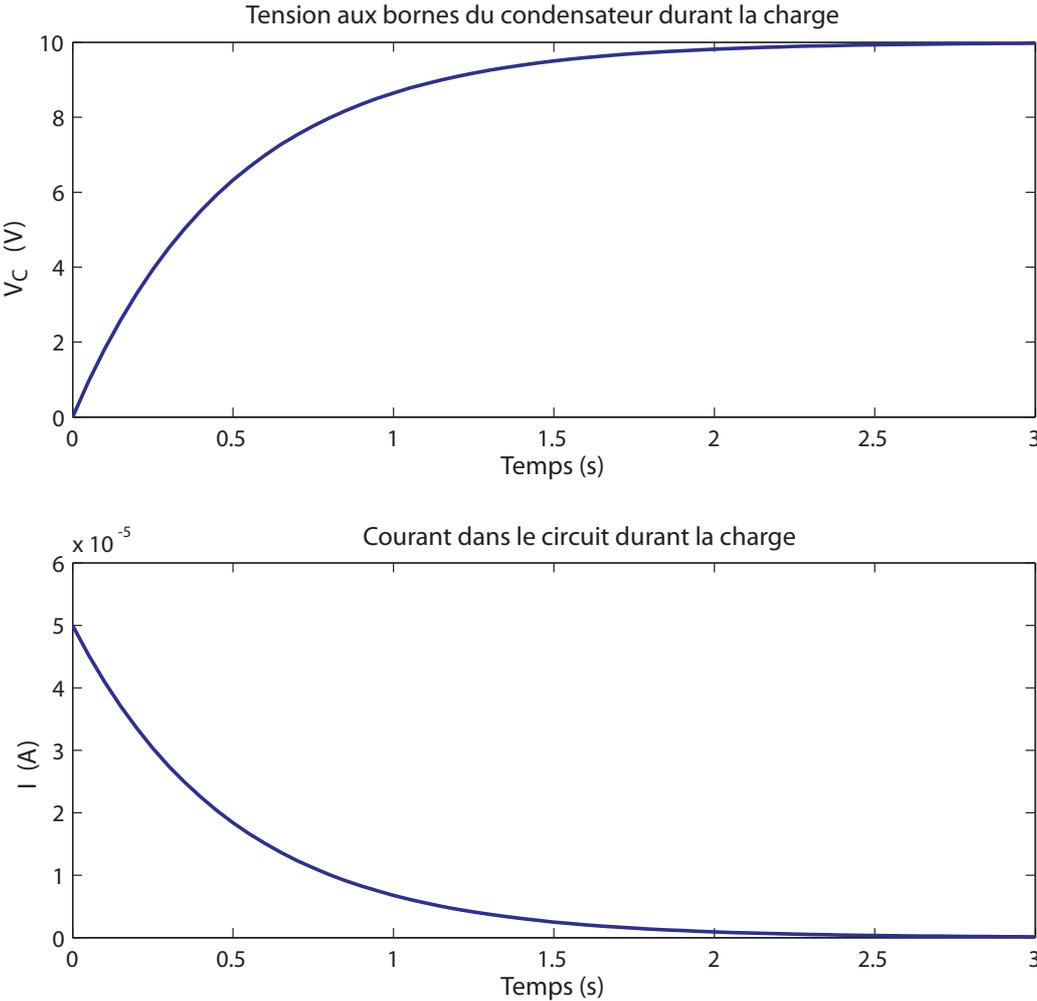
FIG. 2.3 – Charge du condensateur.  $V_0 = 10V$ ,  $R = 50k\Omega$ ,  $C = 10\mu F$ .
