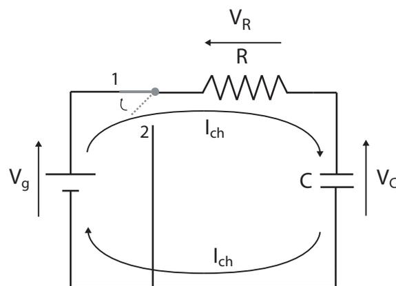
FIG. 2.1 – Charge du condensateur à travers la résistance  $R$ .
