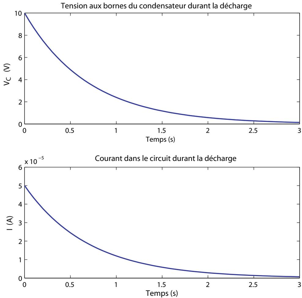
FIG. 2.5 – Décharge du condensateur.  $V_0 = 10V$ ,  $R = 30k\Omega$ ,  $C = 10\mu F$ .
