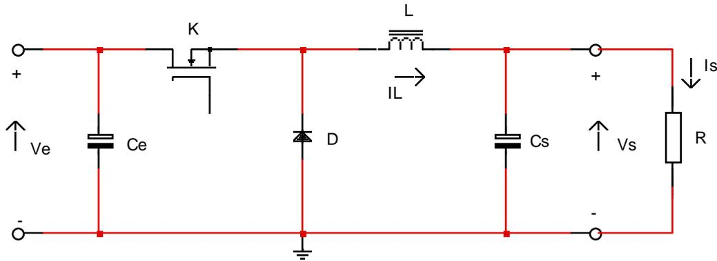
Le circuit est alimenté par une source de tension  $V_e$ , la sortie est chargée par une résistance  $R$  et débite un courant  $I_s$ .
