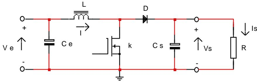
Le circuit est alimenté par une source de tension  $V_e$ , la sortie est chargée par une résistance  $R$  et débite un courant  $I_s$ .
