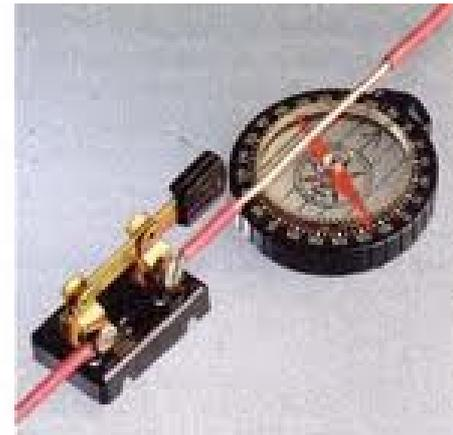
*Expérience d'Oersted: lorsque qu'un courant traverse un fil situé à proximité d'une boussole, l'aiguille aimantée est déviée d'un angle lié à l'intensité du courant.*
