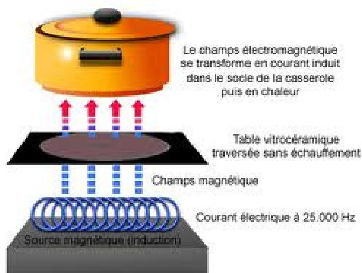
*Principe du chauffage par induction.*
