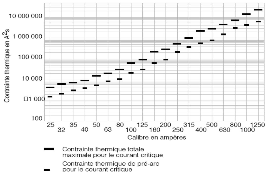
Contraintes thermiques de fusibles à couteaux de type gG
