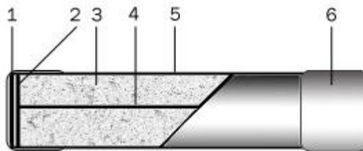
1 : Plaque de soudure ; 2 : Disque de centrage de la lame fusible ; 3 : Silice (permet une coupure franche) ; 4 : Lame fusible ; 5 : Tube isolant ; 6 : Embout de contact.
