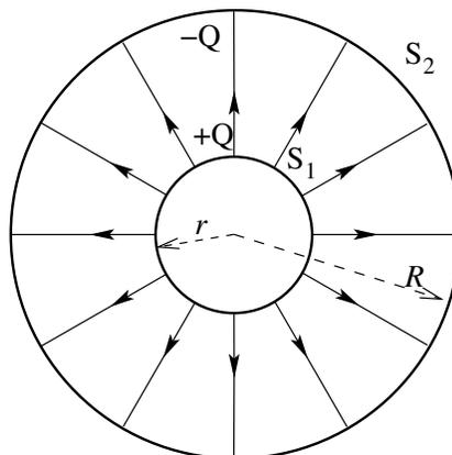
FIG. 9 – Capacité des deux sphères concentriques.
