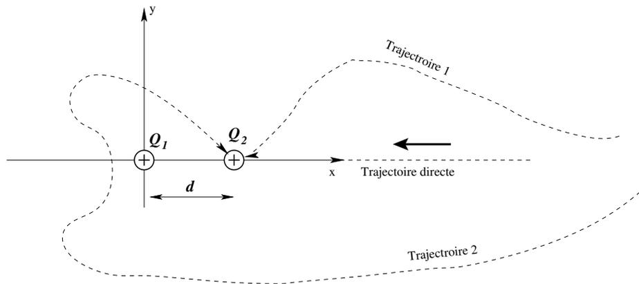
FIG. 3 – Travail de rapprochement de deux charges électriques
