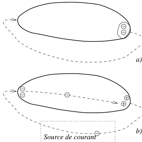
FIG. 11 – Génération d'un courant électrique dans un conducteur.
