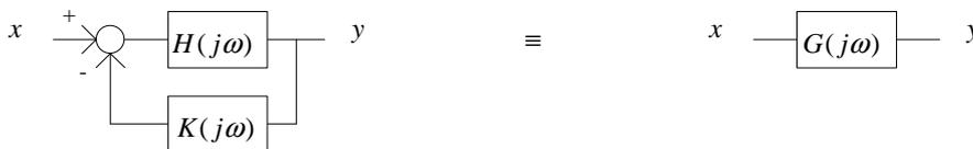
$$G(j\omega) = \frac{H(j\omega)}{1 + K(j\omega)H(j\omega)} \quad T(j\omega) \overset{\Delta}{=} K(j\omega)H(j\omega)$$
