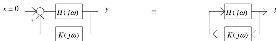
C'est un cas particulier de Système Bouclé à comparateur +/- dans le cas d'une entrée nulle :  $x = 0$
