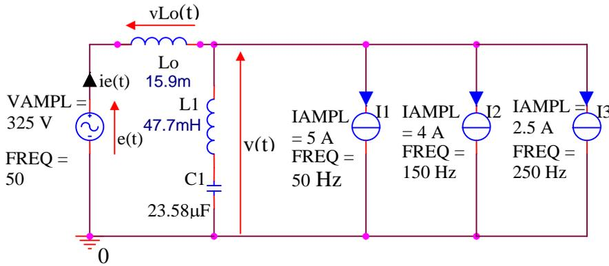
Ce courant non sinusoïdal est source de perturbations dans la ligne d'alimentation en énergie électrique.
