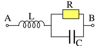
d) Le dipôle A-B précédent constitue la charge d'un onduleur MLI qui lui applique une tension  $v(t)$ . Cette tension peut être approximée par une somme de deux sinusoïdes  $v_1(t)$  de fréquence  $50 \text{ Hz}$  et  $v_2(t)$  de fréquence  $10000 \text{ Hz}$ . On souhaite calculer  $v_R(t)$ , mais le calcul à l'aide des complexes n'est pas directement utilisable car  $v_1(t)$  et  $v_2(t)$  ne sont pas de même fréquence.
