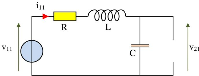
c) Dans le montage ci-contre,  $v_{11}$  est une tension alternative sinusoïdale :  $v_{11}(t) = \hat{V}_1 \cdot \cos(\omega t)$
