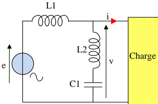
Une source de tension  $e(t) = 100.\cos(50.2.\pi.t) = 100.\cos(100.\pi.t)$  alimente une charge qui consomme un courant  $i(t)$  non sinusoïdal :  $i(t) = 10.\cos(100.\pi.t) + 4.\cos(300.\pi.t)$
