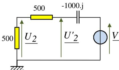
En utilisant la formule du pont diviseur de tension :
