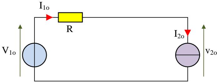
a) Dans le montage ci-contre,  $V_{10}$  est une source de tension continue, et  $I_{20}$  est une source de courant continu.
