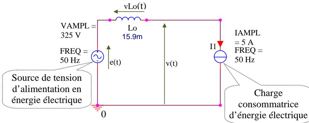
Une source de tension  $e(t) = 230 \cdot \sqrt{2} \cdot \cos(100 \cdot \pi \cdot t) = 325 \cdot \cos(100 \cdot \pi \cdot t)$  alimente une charge qui se comporte comme une source de courant :  $i_1(t) = 5 \cdot \cos(100 \cdot \pi \cdot t)$ . La liaison entre la source de tension et la charge se fait au moyen d'une ligne inductive (modélisée par l'inductance  $L_o$  sur le schéma ci-contre.)
