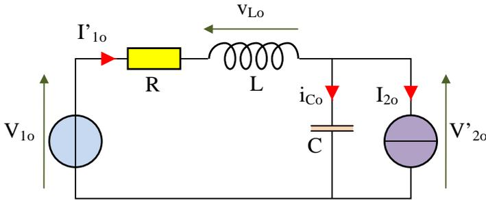
Dans le montage ci-contre,  $V_{10}$  est une source de tension continue, et  $I_{20}$  est une source de courant continu.
