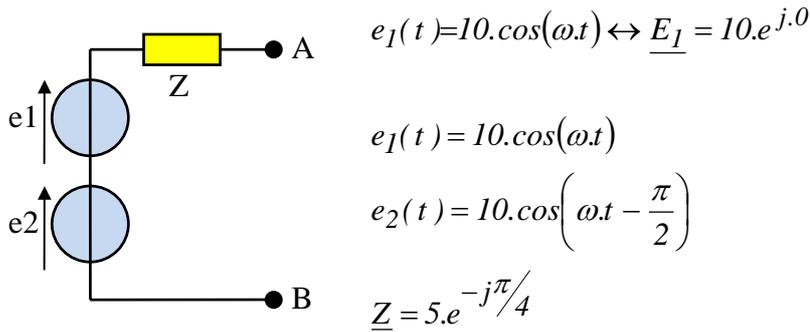
Calculer la tension équivalente de Thévenin  $e_{TH}(t)$  et le courant de court-circuit  $i_{cc}(t)$  du dipôle AB (avec  $i_{cc}(t)$  orienté de A vers B dans le court-circuit).
