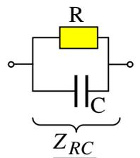
$v_I(t)$  engendre aux bornes de  $Z_{RC}$  une tension  $v_{R1}(t)$
