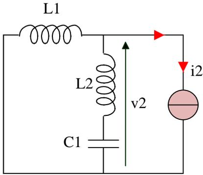
**b)** Sachant que  $i_2(t) = 10.\cos(100.\pi.t)$ , (schéma ci-contre), déterminer la valeur complexe  $\underline{V}_2$  associée à  $v_2(t)$  (indiquer les calculs littéraux puis les résultats numériques complexes).
