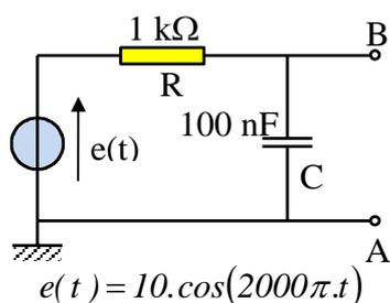
On a calculé le modèle équivalent de Thévenin du dipôle A-B ci contre.
