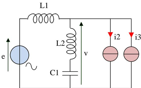
**d)** Sachant que  $e(t) = 100.\cos(100.\pi.t)$ ,  $i_2(t) = 10.\cos(100.\pi.t)$  et  $i_3(t) = 4.\cos(300.\pi.t)$ , (schéma ci-contre), déterminer l'expression numérique de  $v(t)$ .
