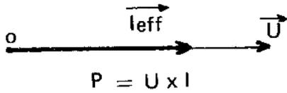
Le courant efficace d'un circuit résistif est un courant actif parce que, en phase avec la tension, il participe entièrement à la puissance utile dégagée.
