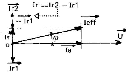
Si l'effet de capacité est prépondérant le courant réactif résultant est  $I_r2 - I_r1$  en avance sur  $U$ ,  $I_{eff}$  est aussi en avance sur  $U$ , sa composante, la étant toujours en phase avec  $U$ .
