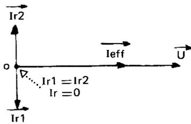
Si l'effet capacitif est égal à l'effet inductif le courant réactif résultant  $I_r = 0$  :  $I_{eff}$  est en phase avec  $U$  et devient le courant actif comme si il n'y avait ni capacité ni inductance.
