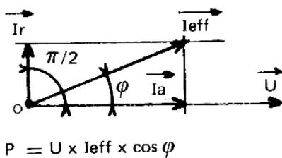
Si le circuit est résistif et capacitif,  $I_{eff}$ , en avance sur  $U$ , donne un courant actif  $I_a$  et un courant réactif  $I_r$  en avance de  $\pi/2$  sur  $U$  et ne donnant aucune puissance utile.
