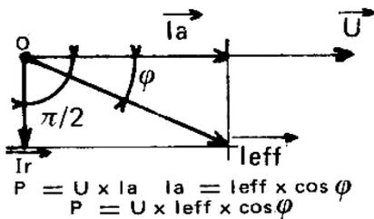
Si le circuit est résistif et inductif, le courant  $I_{eff}$  est déphasé en retard sur  $U$ , donnant un courant actif  $I_a$  et un courant réactif  $I_r$  en retard de  $\pi/2$  sur  $U$  et ne donnant aucune puissance utile
