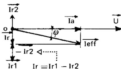
Le courant  $I_{eff}$  détermine deux courants réactifs opposés, l'un  $I_{r1}$  inductif, l'autre  $I_{r2}$  capacitif qui donne un courant réactif résultant  $I_r = I_{r1} - I_{r2}$ , composante de  $I_{eff}$  avec  $I_a$ .
