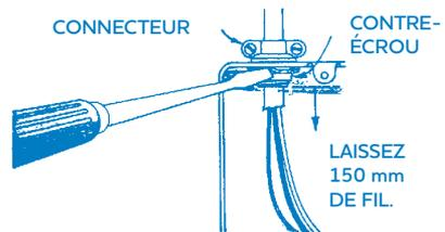
ENLEVEZ LE CONTRE-ÉCROU, TIREZ LE CÂBLE DANS LE CONNECTEUR, SERREZ LES VIS, PUSSEZ LE CONNECTEUR DANS LE TROU, FAITES GLISSER LE CONTRE-ÉCROU POUR LE REMETTRE ET SERREZ AVEC UN TOURNEVIS.
