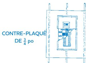
Hauteur d'installation de la planche de fixation et du panneau de distribution - Schéma 10
