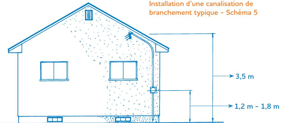
Installation d'une canalisation de branchement typique - Schéma 5
