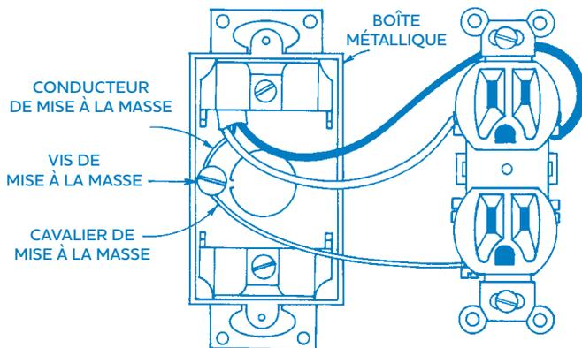
Connexions d'un conducteur de mise à la masse d'une prise - Schéma 19
