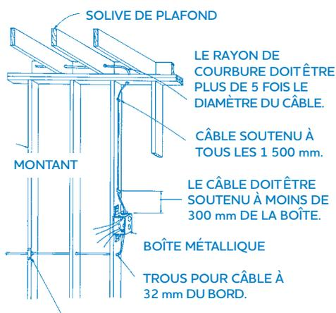
LA PLAQUE MÉTALLIQUE PROTÈGE LE CÂBLE SITUÉ À MOINS DE 32 mm DU CÔTÉ AVANT DU MONTANT.
