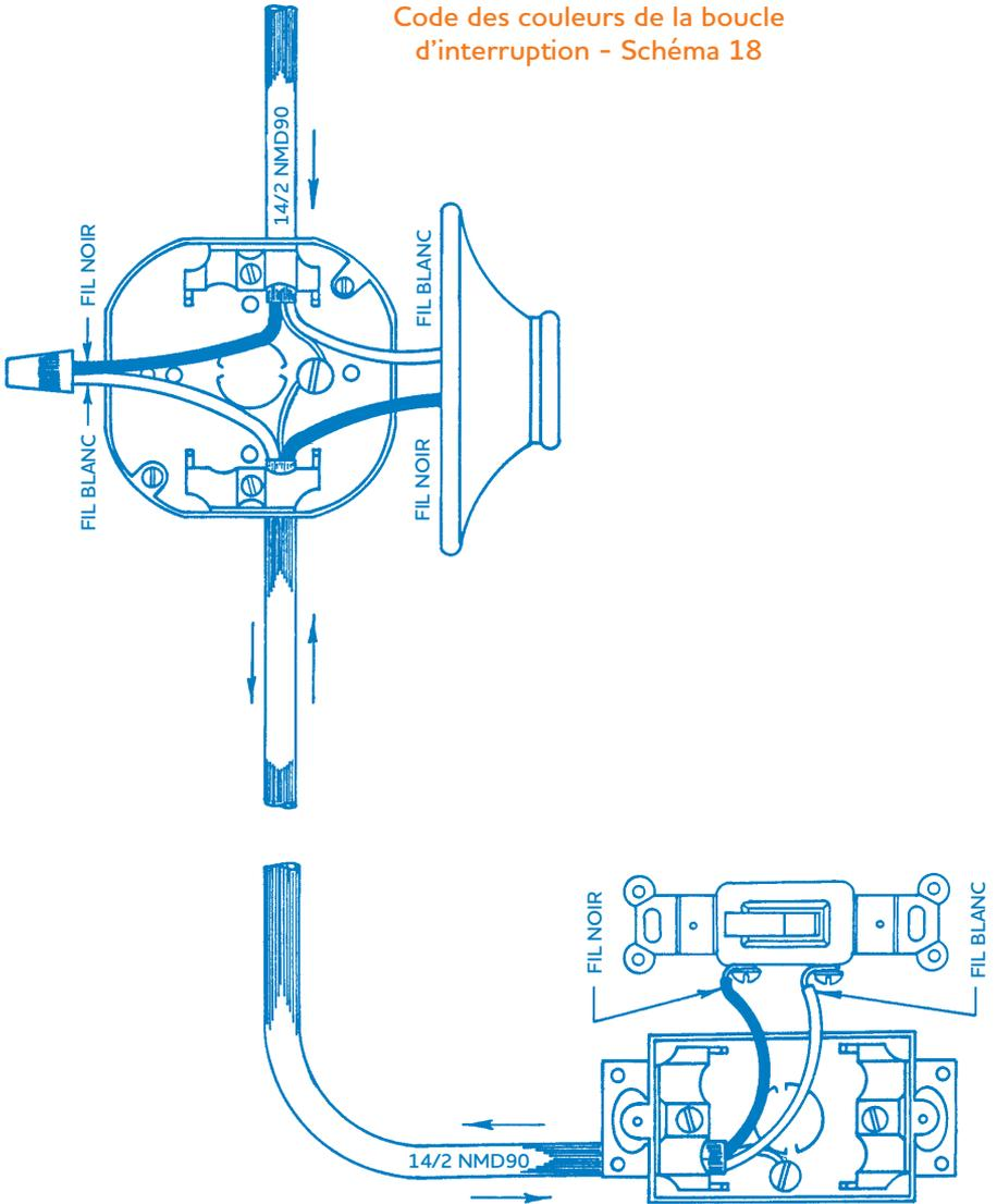
Dans certains cas, il faut connecter des prises sectionnables. À cette fin, utilisez un câble à 3 conducteurs de type NM, au lieu d'un câble à 2 conducteurs. Utilisez une prise double comme prise sectionnable, mais du côté où les conducteurs sous tension sont connectés, enlevez la languette d'interruption. Connectez ensuite le conducteur noir à l'une des bornes de couleur laiton et le conducteur rouge à l'autre borne de couleur laiton. Connectez le conducteur blanc à la vis argentée (schéma 17).
