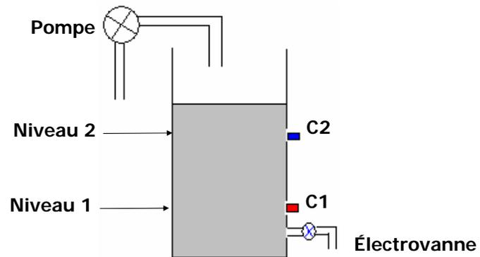
Lorsque le niveau d'eau est inférieure au niveau 1 (Capteur C1), on déclenche la pompe pour remplir le réservoir.
