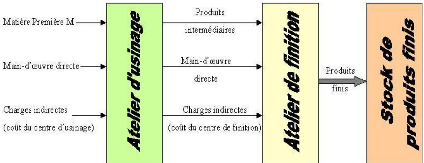
On traite une matière première M dans un atelier d'usinage, pour obtenir un produit intermédiaire, qui passe, sans stockage, dans un atelier de finition, pour devenir un produit fini mis en stock et destiné à la vente.
