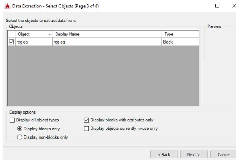
On passe à l'étape suivante qui dresse une liste des paramètres qui sont disponibles pour l'extraction, encore une fois on doit sélectionner seulement ce qui nous sera utile dans ce cas-ci, soit les coordonnées et le nom des regards par exemple.
