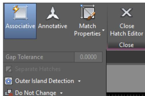
Le sous-menu options permet d'accéder aux outils contrôlant la détection des îlots et de l'ordre de traçage des hachures
