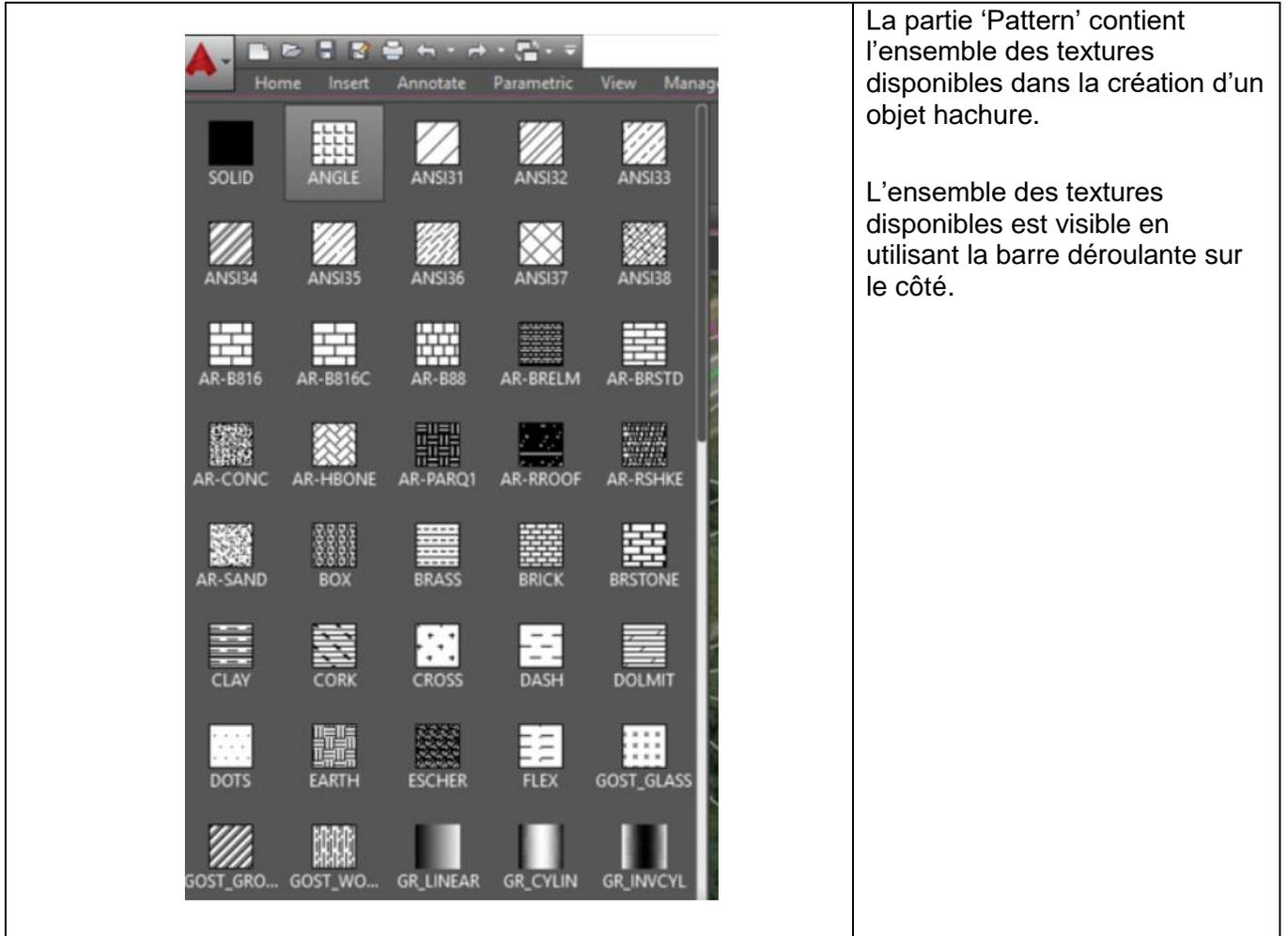
Le sous panneau 'Properties' quant à lui permet d'éditer plusieurs autres paramètres d'un objet hachure, soit en changeant son type (menu Pattern : texture, solid ou gradient)
