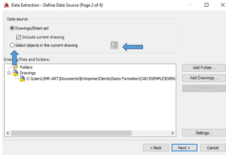
Dans ce cas-ci nous sélectionnerons des objets dans le dessin courant 'Select object in the current drawing' et l'icône qui permet la sélection directe à l'écran.
