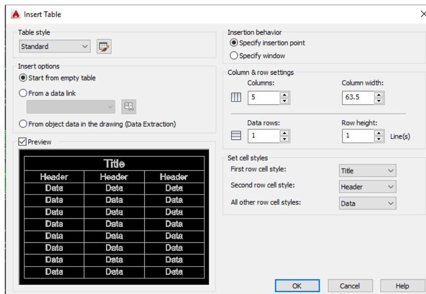
On peut insérer un tableau vide, ou en utilisant des données existantes comme un fichier Excel par exemple ou encore en effectuant une extraction de données, cette fonction sera vue dans la section 'fonctions avancées blocs'. Les autres options déterminent si le tableau est inséré à un point ou
