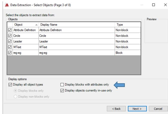
Et on désélectionne les autres options, on obtient l'écran suivant
