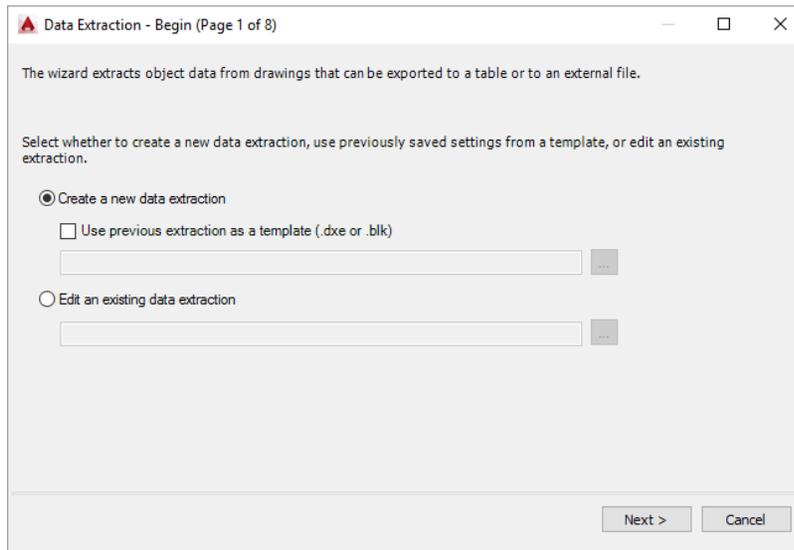
si on a déjà effectué une extraction semblable et qu'on a sauvegardé le fichier on peut sélectionner l'option du bas 'Edit an existing data extraction'
