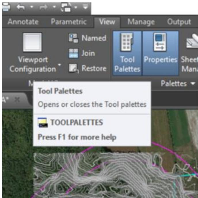
La palette suivante, présentée à la page suivante, permet d'accéder à quelques outils utiles afin de positionner les sections ou coupes.
