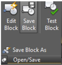
**Edit Block** : Ferme la fenêtre actuelle afin de permettre l'édition d'un autre bloc choisi dans la liste des blocs du dessin.
