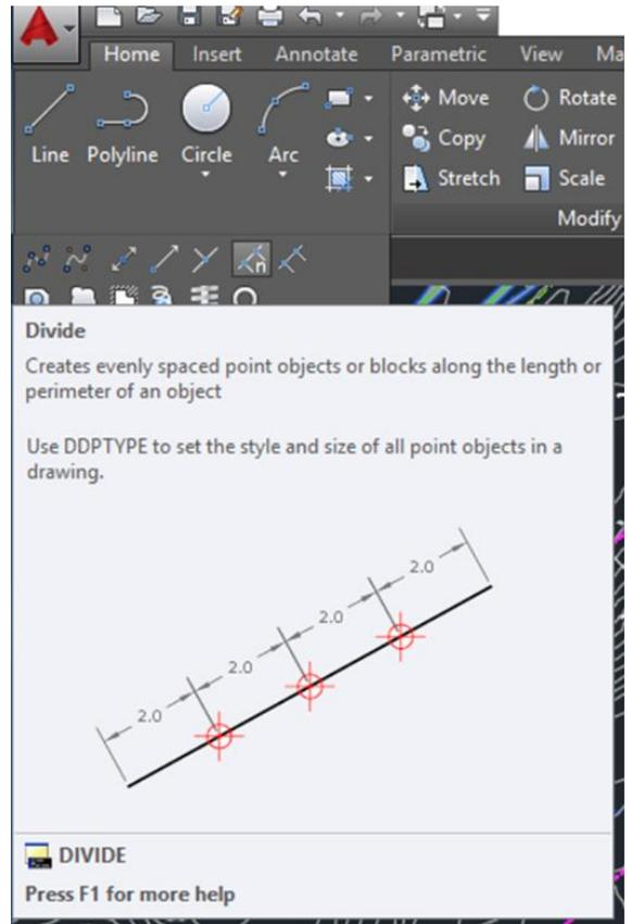
Une commande permet de régler l'apparence des points qui sont insérés le long du polyligne, en même temps que le bloc choisi si on prend cette option.
