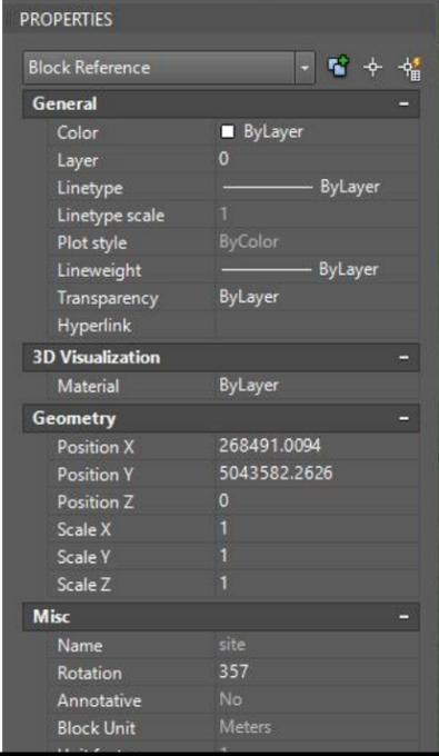
Boîte des propriétés – permet de modifier les paramètres d'objets lorsqu'ils sont sélectionnés, comme changer de calque, type de ligne, hauteur du texte, épaisseur polygline – on peut utiliser cette boîte avec objets sélectionnés seulement, sinon change les valeurs par défauts
