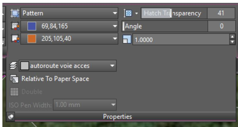
Les couleurs, soit de la texture ou du fond, la transparence, l'angle et l'échelle. On peut aussi de cette boîte changer le calque sur lequel est le hachurage, et régler l'échelle en fonction de celle de la présentation
