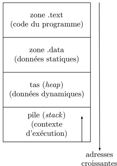
Lorsqu'on écrit un programme en C, on ne se préoccupe pas de savoir dans quelle zone du processus va se retrouver telle fonction ou telle donnée : c'est le travail du compilateur. Mais lorsqu'on écrit du code assembleur, on doit définir précisément la structure du programme. On utilise pour ça des directives, qui sont des commandes qui ne font pas partie du langage assembleur mais qui aide le programme d'assemblage à faire son travail.
