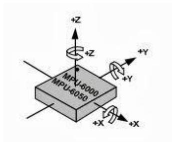
Attention, les axes xy sont inversés sur la sérigraphie du PCB. (X = y et Y = -x)
