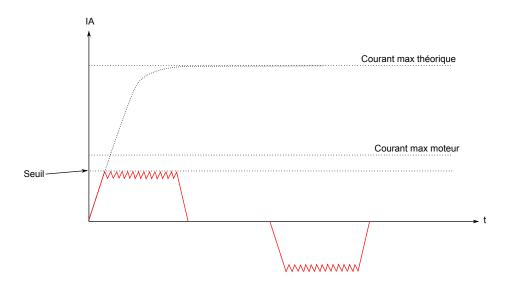
Les variations du courant pendant le découpage ont un période inférieure à celle de l'oscillateur. Plus l'oscillateur est rapide, plus ces variations ont une amplitude faible. En ajustant le seuil de courant, on peut ainsi réguler l'intensité atteinte pendant l'impulsion de commande. Cela permet de réduire notablement la dissipation lorsque la charge appliquée au moteur le permet. Le même dispositif peut d'ailleurs être appliqué à un moteur à courant continu pour réguler le courant.
