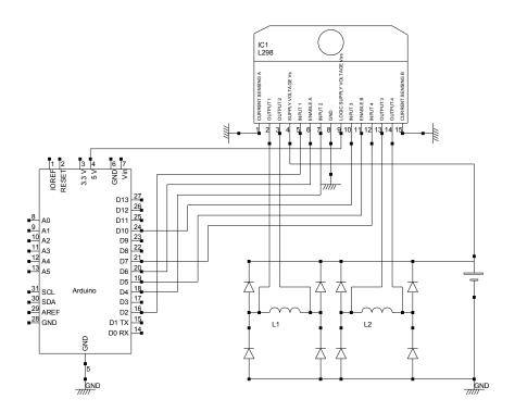
Le pont A sert à alimenter la phase A, le pont B à alimenter la phase B. Les deux sorties du pont A sont OUTPUT1 et OUTPUT2. Le pont A est piloté par les trois entrées logiques INPUT1, INPUT2 et ENABLEA. Lorsque ENABLEA=1, un sens du courant est obtenu avec INPUT1=1 et INPUT2=0, alors que le sens opposé est obtenu avec INPUT1=0 et INPUT2=1. Lorsque ENABLEA=0, le pont est inactif (le courant est nul).
