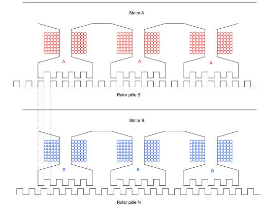
Dans un moteur hybride, il y a un faible couple même en l'absence de courant, qui bloque le rotor dans une position d'alignement, soit avec les pôles A soit avec les pôles B. Ce couple permet souvent de bloquer le moteur au repos sans lui fournir du courant (à condition que la charge au repos soit faible).
