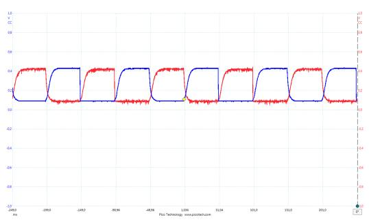
Le mode utilisé est le mode 1 (une phase alimenté à la fois). Le sens du courant n'apparaît pas. On voit que cette durée de pas est largement suffisante pour l'établissement du courant. La fiche du constructeur donne pour une phase du moteur L=90~mH et  $R=40\Omega$ , ce qui fait un temps L/R=2,5~ms, en accord avec cet oscillographe.
