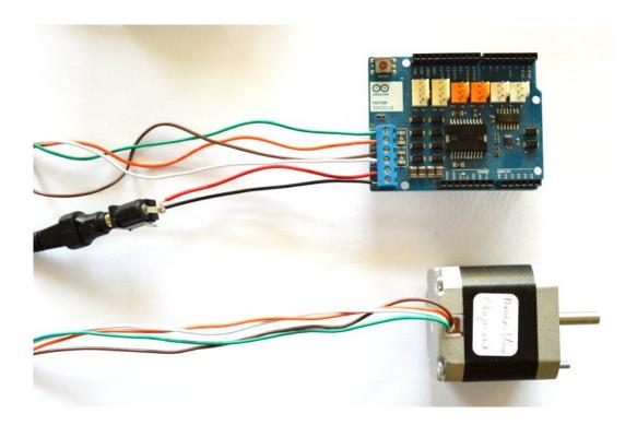
Pour déterminer les fils de chaque phase, il faut utiliser un ohmmètre. L'alimentation du moteur est faite directement sur le shield par un bloc secteur  $12\ V$ . La liaison Vin a été coupée de manière à éviter une alimentation accidentelle par le port USB.
