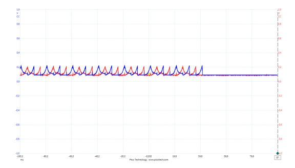
Pour ces deux dernières durées, le courant maximal n'est pas atteint au cours d'un pas, mais le moteur tourne bien. Dans ce régime de fonctionnement, le moteur émet un sifflement dont la fréquence est celle des pas.
