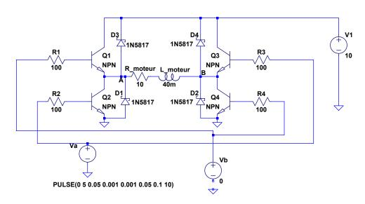
Le bobinage est représenté par une résistance et une inductance. Lorsque  $Va=5\ V$  et Vb=0, les transitors Q2 et Q3 sont passants et un courant positif circule dans le moteur de B vers A. Inversement, lorsque Va=0 et  $Vb=5\ V$ , un courant positif circule de A vers B. Lorsque les deux tensions de commande sont à zéro, le courant dans le bobinage est nul. Les diodes permettent au courant de ce réduire continûment lorsque les transistors sont bloqués (diodes de roue libre)
