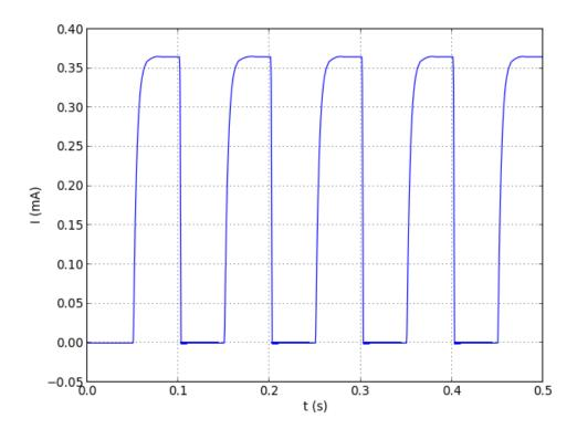
La durée des pas est de 100 ms (en réalité, il y a une inversion du sens du courant qui n'est pas introduite dans la simulation). On voit bien le régime transitoire d'établissement du courant. Pour obtenir le couple maximal, il faut que la durée des impulsions soit supérieure au temps d'établissement du courant.
