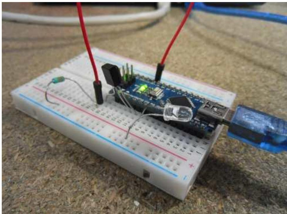
Les télécommandes infra rouge utilisent en général un signal constitué d'une suite de « rafales » d'oscillations de fréquence déterminée (38Khz le plus souvent), l'existence ou pas du signal et/ou les transitions de signal constituant des « zéro » et « un » du code émis.
