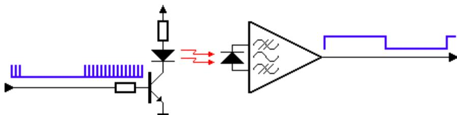
Avec un logiciel adapté, on peut lire les durées des codes selon les touches de la télécommande actionnées.
