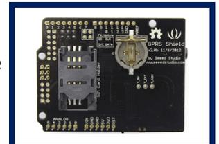
La communication entre le module et une carte Arduino est réalisée par la **liaison série asynchrone** : UART ou une liaison série logicielle.
