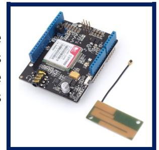
Le module est livré avec une antenne patch déportée. Un connecteur au dos de la platine est prévu pour recevoir une carte SIM ainsi qu'une pile Lihtium CR1220.
