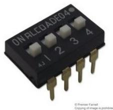
Vous utiliserez un seul des 4 boutons. Le bouton ne peut être branché directement sur l'entrée de la carte. Il va nécessiter l'utilisation d'une résistance de pull-up
