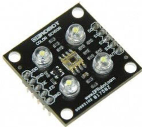
Figure 11 : le capteur de couleur TCS3200 DFRobot présenté en Annexe
