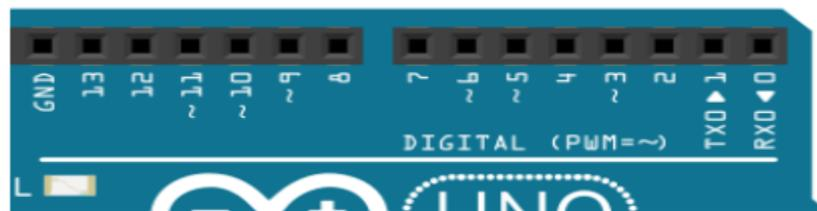
Figure II 5 : les entrées et les sortie numérique
