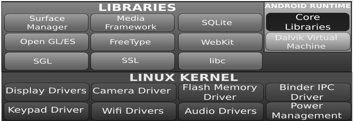
Le kernel linux évolue avec les versions du SDK : 2.6.24 avec le SDK 1.5, 2.6.29 pour les SDK suivants
