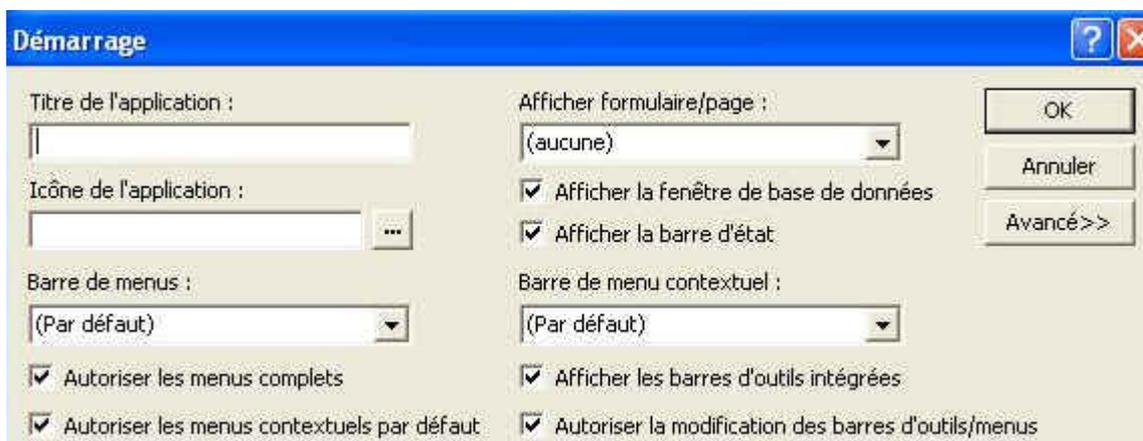
Il suffit de mettre le nom de notre formulaire d'entrée dans la case **Afficher Formulaire / page** pour que notre formulaire soit automatiquement affiché au démarrage de l'application Access.
